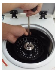
Utensile per rotore senza dado
