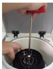
Utensile per rotore con dado
