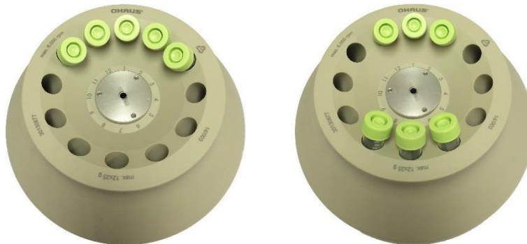
Abbildung.13-1 FALSCH Abbildung.13-2 KORREKT (6 Röhren)
