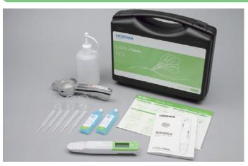
Measurement range: 100~9,900 ppm (NO<sub>3</sub>-), 23~2,200 ppm (NO<sub>3</sub>-N)
